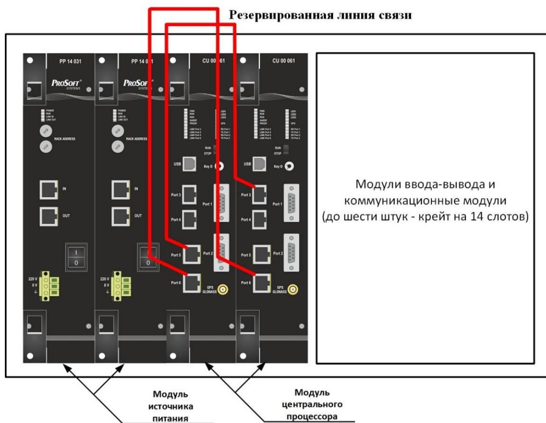
Рисунок 9 - Базовый крейт в резервированном варианте
